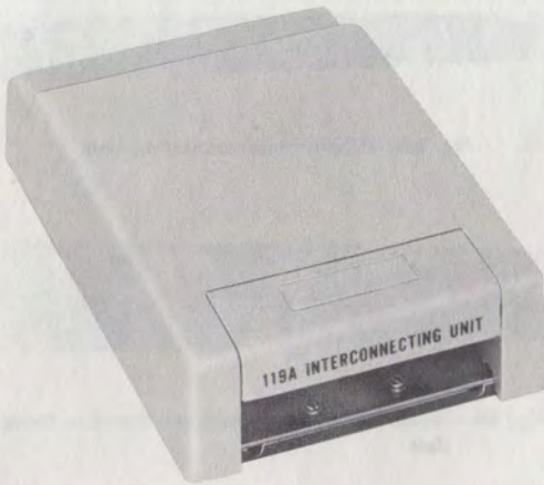
Fig. 15—119A Interconnecting Unit
