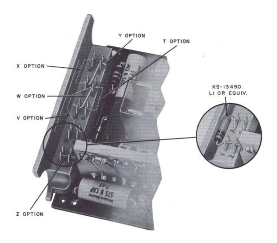
Fig. 6 — Option Block — Handle, 400D KTU
