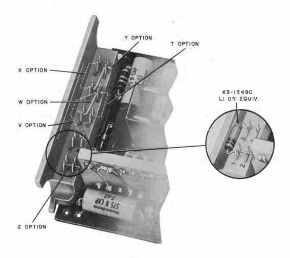
Fig. 6 — Option Block — Handle, 400D KTU
