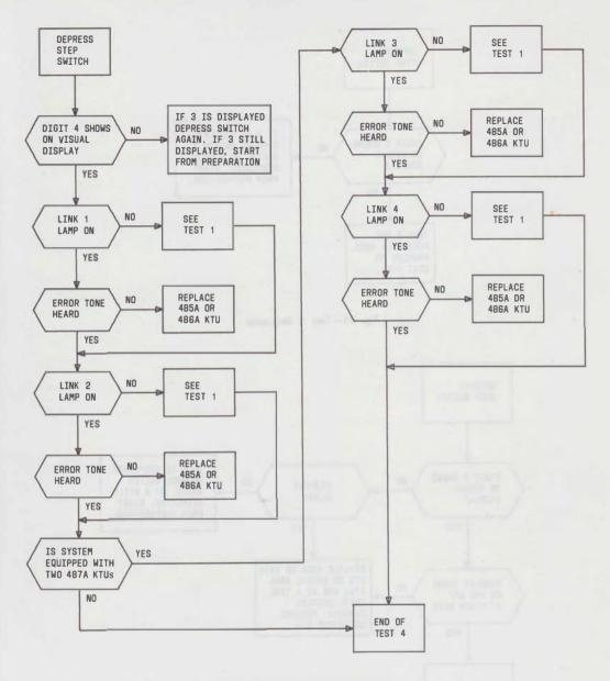
Fig. 23-Test 4 Sequence-Error Tone
