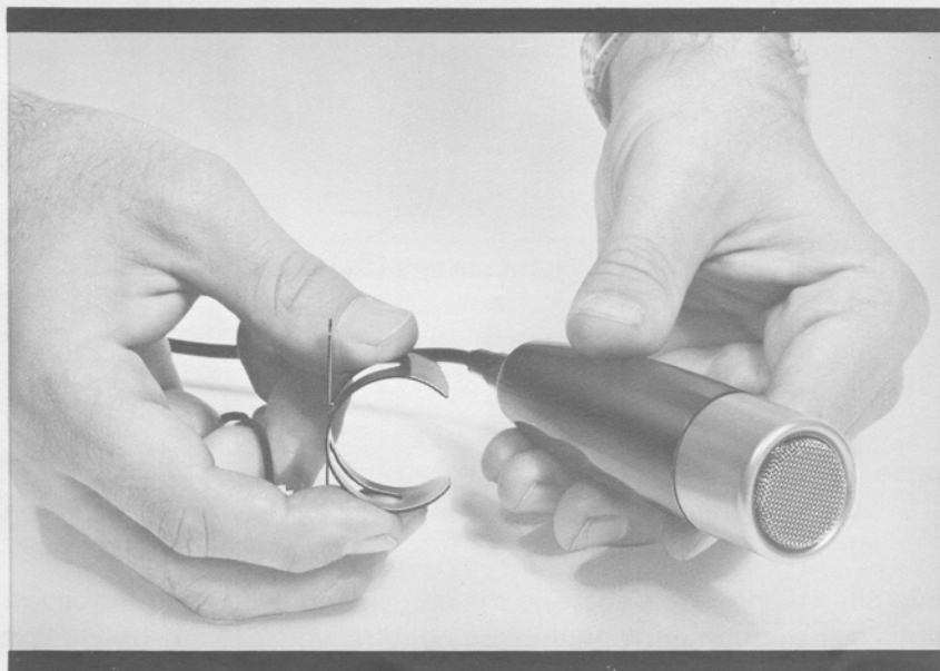
Fig. 5 Installing the lavalier assemblies
